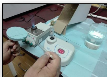
8- Etalement au râteau de la quantité déposée de la suspension (Pour une répartition homogène des bactéries à la surface de l'empreinte)
