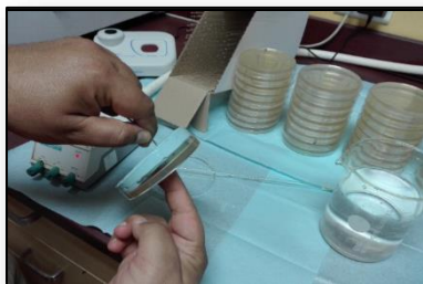
10- Mise en contact avec la boîte de gélose nutritive (Boîte correspondant à 5 minutes de décontamination)
