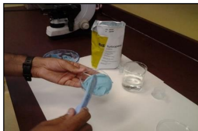
2- Réalisation de l'empreinte sur la boîte de Petri à l'alginate
